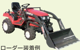
ミニローダー装着例 アングルグレーダも装着できます。
